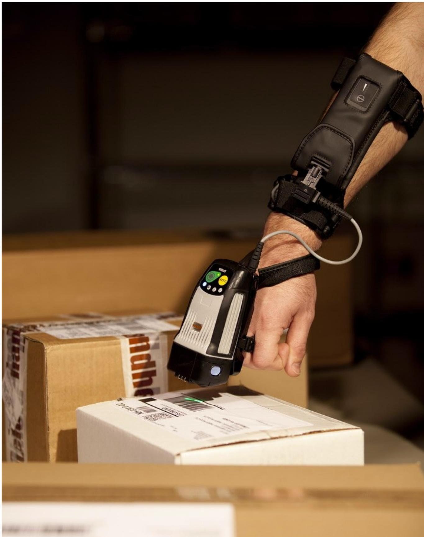
Дизайн SP400X оптимизирован для упрощения его эксплуатации, а сам импринтер выполнен из гипоаллергенных материалов для максимального комфорта пользователей. Степень защиты IP53 означает, что данное устройство защищено от пыли и капель воды, что расширяет диапазон условий применения и круг решаемых задач.
